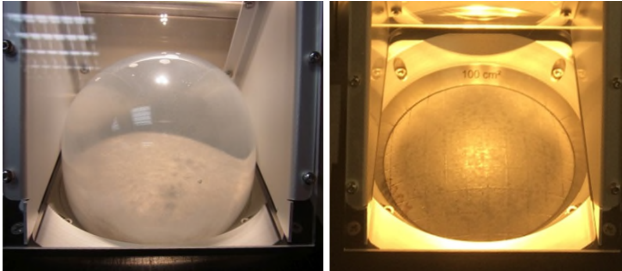
Abbildung 6: Zwei Proben unterschiedlicher Produkte während der Prüfung zur Bestimmung der Höhe der dynamischen Wassersäule; Bei der linken Probe traten bereits während des Martindale-Verfahrens Delaminierungen von Vlies und TPU-Beschichtung auf, die zusammen mit Beschädigungen der oberseitigen TPU-Beschichtung zu der deutlich erkennbaren „Wasserblasenbildung“ bei einer Höhe der Wassersäule von ca. 4 m führte; In der rechten Abbildung ist die deutliche Aufwölbung einer dichten Probe nach dem Martindale-Verfahren bei einer Wassersäulenhöhe von ca. 10 m zu sehen
