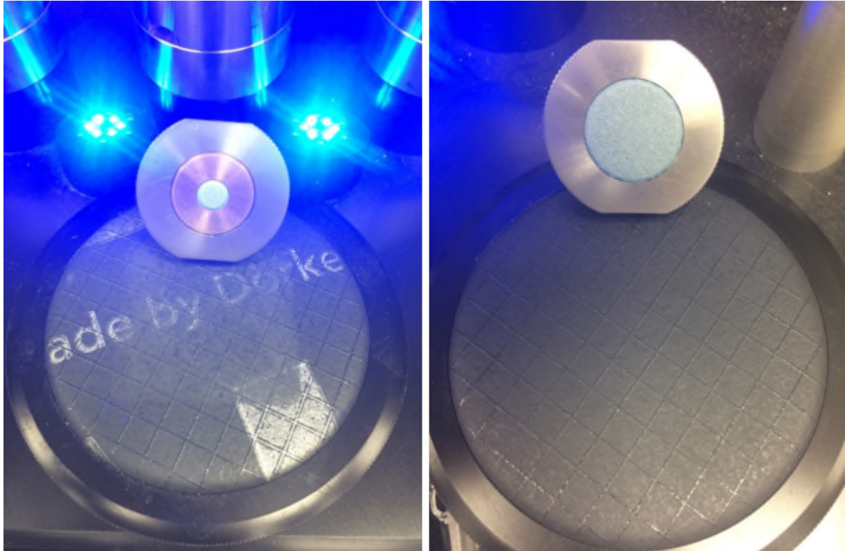
Abbildung 4: Oberflächlicher Abrieb bei reduzierter Reibfläche und 50 Touren (links) sowie bei "normalen" Arbeitseinsatz und 100 Touren (rechts); Während in der linken Abbildung ein deutlicher Materialabtrag erkennbar ist, wurde die Bahnenoberfläche in der rechten Abbildung nur aufgeraut und erscheint deswegen im Bereich mit Kontakt zum Arbeitseinsatz „matter“ als im Randbereich.
